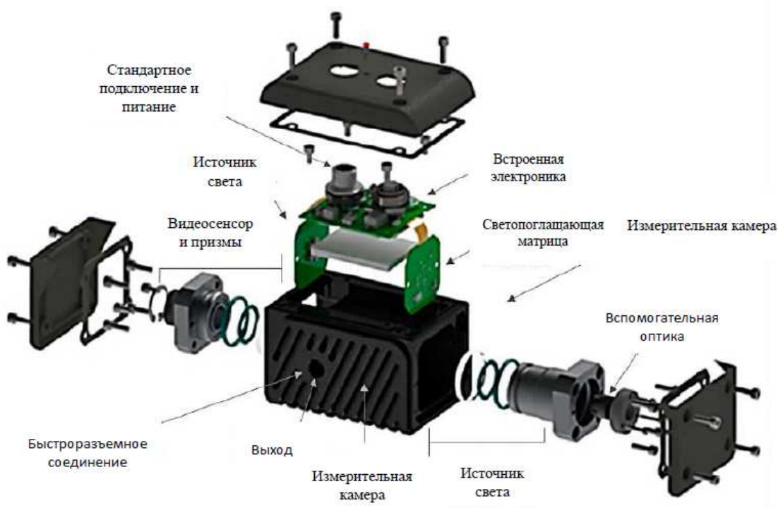
Рис. 2. Возможная компоновка измерительной части датчика
